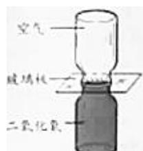
25. 如图所示，两个相同瓶子的瓶口相对，之间用一块玻璃板隔开，上面的瓶中装有空气，下面的瓶中装有密度比空气大的红棕色二氧化氮气体。抽掉玻璃板后，可以看到，两个瓶中的气体会混合在一起，最后颜色变得均匀，这属于\_\_\_\_\_现象。
